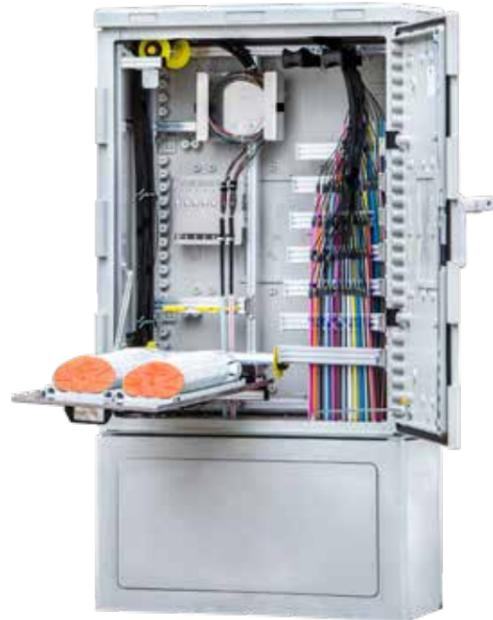
Das Einbauset für den Kabelverzweiger KVZ 06s3 ist speziell für die Anwendung im FTTx-Umfeld designt und beinhaltet ein Kabelmanagement für ankommende Kabel, ein Rohrmanagement für abgehende Kabel, eine Bündelader- und Kabelführung und ein klappbares Spleißmanagement.
