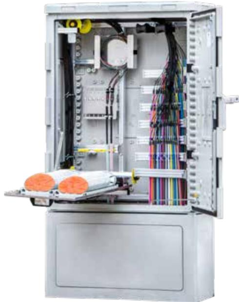
Das Einbauset für den Kabelverzweiger KVZ 04s3 ist speziell für die Anwendung im FTTx-Umfeld designt und beinhaltet ein Kabelmanagement für ankommende Kabel, ein Rohrmanagement für abgehende Kabel, eine Bündelader- und Kabelführung und ein klappbares Spleißmanagement.
