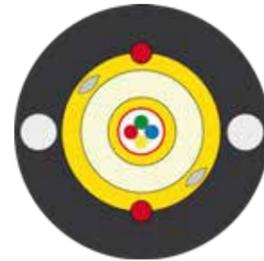
DROPTIC® LM4 ist ein außen/innen Drop Kabel, hergestellt für die außen nach innen Verlegung. Das Kabel kann auf lange Distanzen eingezogen oder auf eine Distanz bis zu 70 Meter gehängt werden. Das zwei in eins Kabel besteht aus einem robusten HDPE Mantel für die Außenverlegung. In Inneren befindet sich dann ein Innenkabel mit LSZH Mantel, das nach Absetzen des Außenmantels einfach als Innenkabel weiter verlegt wird.
