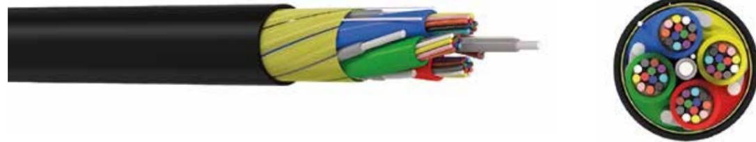
SKM ProfiLIGHT FTTx-Microcable sind nach allen aktuellen Normanforderungen gefertigt. Die Kabel können mit allen marktüblichen Fasertypen SM gefertigt werden, vorwiegend werden hier biegeunempfindliche Fasern eingesetzt. Auslieferung der Kabel je nach Type auf Kabeltrommel zwischen 2000 und 6000 Meter.
