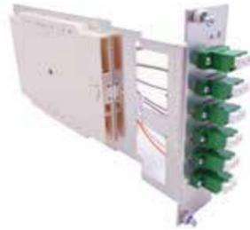
SKM ProfilIGHT LAN-Baugruppenträger Modul, 3 HE zum Einschleiben in den 19"-Baugruppenträger. An die Moduleinheit sind die Spleißkassette und die Überlängenkassette verschraubt. Auf einer Seite wird gespleißt, auf der anderen Seite werden die Überlängen abgelegt.
