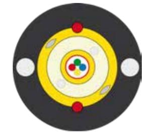
DROPTIC® LM3 ist ein außen/innen Drop Kabel, hergestellt für die außen nach innen Verlegung. Das Kabel kann auf lange Distanzen eingezogen oder auf eine Distanz bis zu 70 Meter gehängt werden. Das zwei in eins Kabel besteht aus einem robusten HDPE Mantel für die Außenverlegung. In Inneren befindet sich dann ein Innenkabel mit LSZH Mantel, das nach Absetzen des Außenmantels einfach als Innenkabel weiter verlegt wird.
