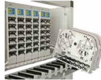
eFOS 19"-Modulträger zum Einbau in 19"-Schränke. Aufnahme von 10 Stück eFOS-Modulen in senkrechter Anordnung. Die Module werden nach unten herausgedreht und können zum Spleißen herausgenommen werden. Jedes Modul ist einzeln durch 5 mm-Röhrchen angebunden, durch welche die Bündeladern in das Modul geführt werden. Die Patchkabel werden über einen Kabelmanager geordnet weggeführt.
