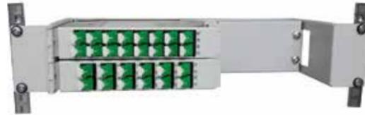
eFOS 19"-Modulträger zum Einbau in 19"-Schränke. Aufnahme von 2 Stück eFOS-Modulen (1,0 HE) in horizontaler Anordnung. Die Module werden, je nach Einbau des Modulträgers nach rechts oder links horizontal herausgedreht und können zum Spleißen herausgenommen werden. Jedes Modul ist einzeln durch 5 mm-Röhrchen angebunden, durch welche die Bündeladern in das Modul geführt werden.
