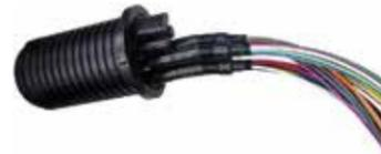
Bei diesem Einführungsset wird eine größere Anzahl von Mikroröhrchen in einem Port muffenseitig längswasserdicht vorinstalliert. Dies ist vor allem bei der Anwendung mit einer hohen Anzahl an niedrigfasrigen Abzweigkabeln, wie zum Beispiel im Drop Bereich von FttH-Netzwerken, eine bewährte Lösung. Die zweite Seite wird mit den verlegten Röhrchen verbunden. Nicht verwendete Röhrchen müssen spätestens bei der Muffeninstallation mit Endkappen verschlossen werden.
